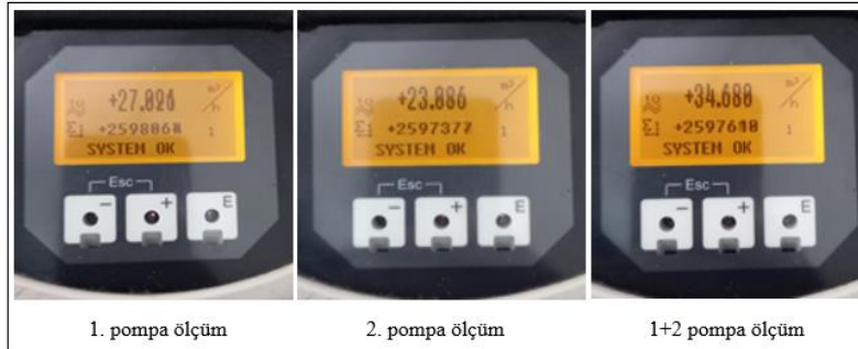
Şekil 5. Mevcut pompa grubuna ait debi ölçümleri.
