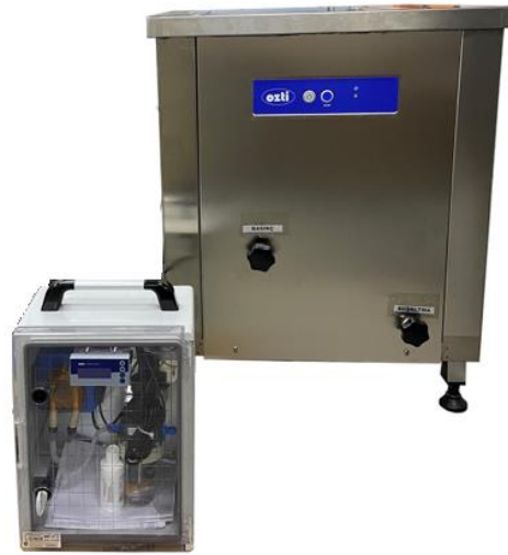
Şekil 6. Ozon destekli dezenfeksiyon sağlayan sebze yıkama makinası prototipinin görseli.
